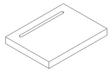
occorre considerare l'intero percorso utensile calcolabile sommando il tempo macchina necessario all' entrata (foratura) dell'utensile nel pezzo al tempo macchina necessario ad effettuare la scanalatura facendo lavorare i taglienti laterali della fresa
